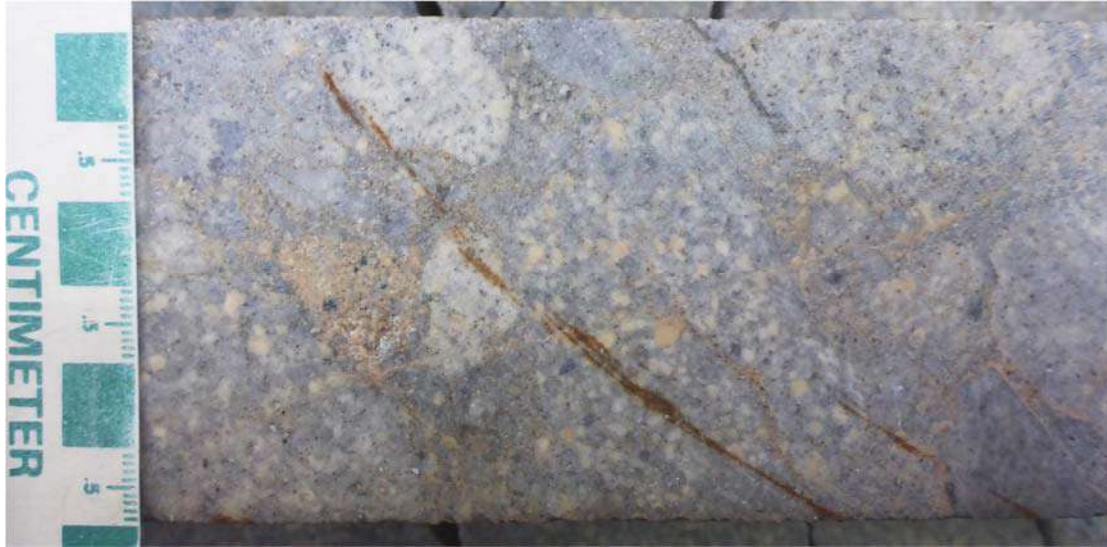
Figure 7.8 Intrusion breccia. PADDH-023, 44.0 m.
